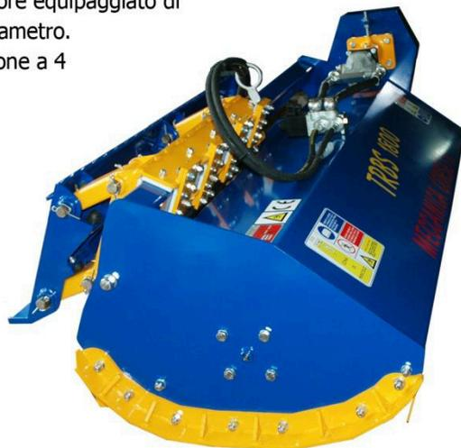
Le fiancate laterali sono dotate di slitte e nervature di rinforzo. Grazie al sistema di spostamento è ideale per la pulizia e la manutenzione di argini nell'assoluta sicurezza dell'operatore evitando il rischio di ribaltamento dovuto a possibili cedimenti del terreno. La velocità degli organi di taglio e la solidità della struttura permettono di tritare finemente la vegetazione.
